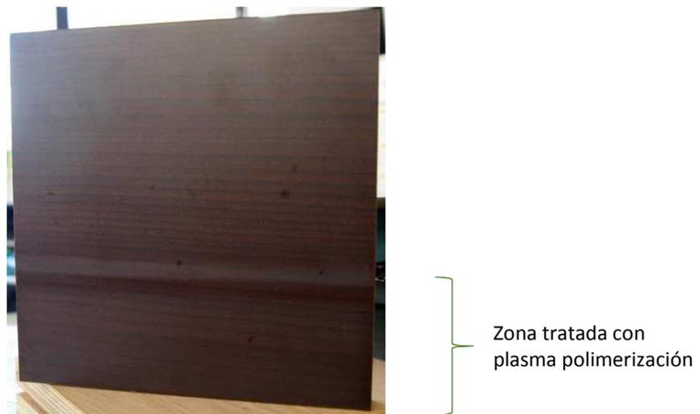
Figura 2.- Muestra tratada con plasma polimerización para aumentar la hidrofobicidad.
