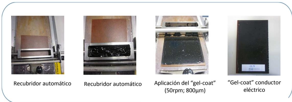
Fig.2. Aplicación del “gel-coat” al sustrato composite.
